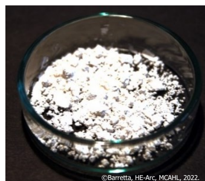
Figure 125 : Methocel™ A4m avant dissolution dans un solvant.
