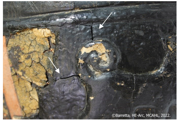
Figure 237 : Fissures après séchage du consolidant.
