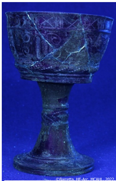
Figure 228 : Observation en UV du calice 3283. La fluorescence indique des collages. Longueur d'onde UV 365 nm.
