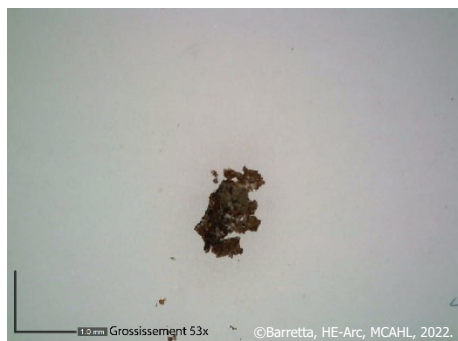
Figure 91 : Vue au microscope digital du prélèvement SCN1 avant spot-test d'identification d'huile siccative.
