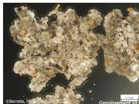
Figure 74 : Vue au microscope optique d'un prélèvement du mortier de jonction.
