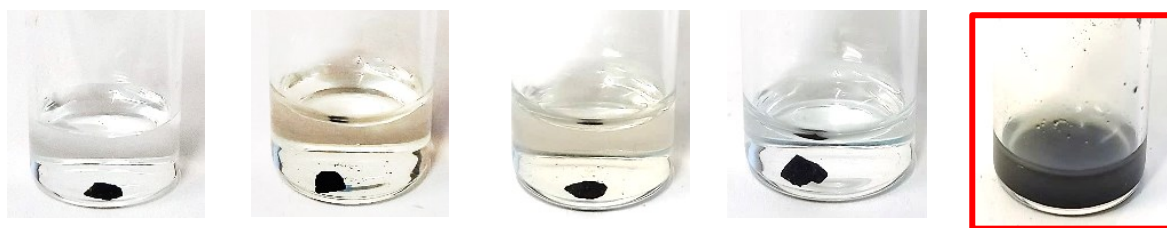
Figure 55 : Test de solubilité de la couche noire prélevée sur le registre central. De gauche à droite : Eau, éthanol, acétone, isooctane, mélange de trois solvants (en rouge)
