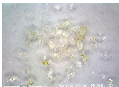
Echantillon de colophane moderne avant et après spot-test d'identification.
