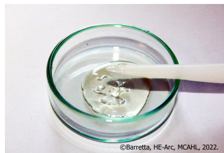
Figure 56 : Gel d'agar-agar semi-rigide prêt à être appliqué.
