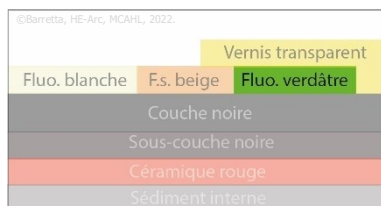
Schéma 9 : Fluorescence verdâtre, emplacement stratigraphique.
