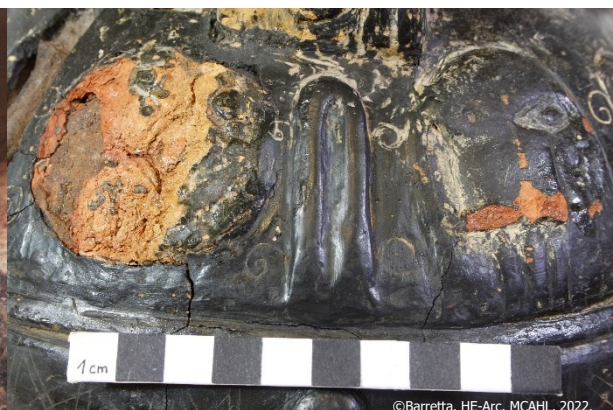
Figure 176 : Lacune dans le mascaron de la frise supérieure, face D.
