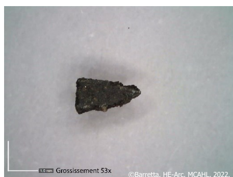
Figure 85 : Vue au microscope digital du prélèvement CN1 avant spot-test d'identification de l'huile siccative.
