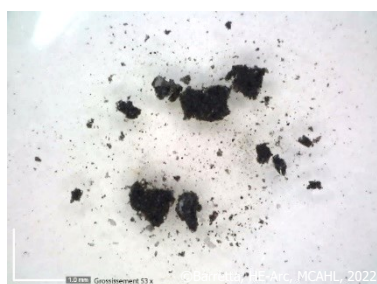
Echantillon de peinture moderne à base d'huile siccative, avant et après spot-test d'identification.
