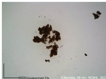
Figure 98 : : Vue au microscope digital du prélèvement DM2 après spot-test d'identification d'huile siccative.
