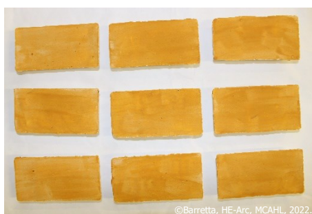
Figure 119 : Eprouvettes enduite de l'apprêt de col de peau.
