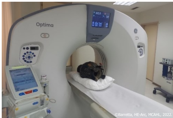
Figure 194 : Tomographie en cours sur le vase 3272.
