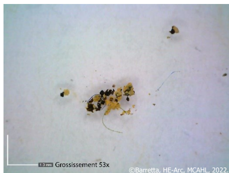
Figure 79 : Vue au microscope digital du prélèvement FS2 avant spot-test d'identification des oxydes de fer.
