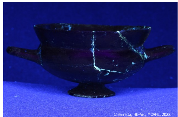
Figure 229 : Observation en UV du calice 3293. La fluorescence indique des collages. Longueur d'onde UV 365 nm.
