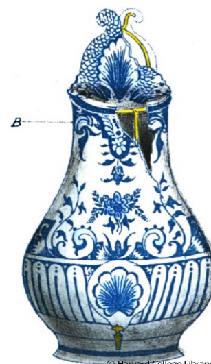
Figure 16 : Illustration issue du manuel de Ris-Paquot, imageant la manière de restaurer une céramique par l'ajout de structure en fil de fer.
