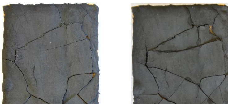
Figure 126 : Avant et après consolidation de l'éprouvette avec de l'Aquazol®200 à 10% dans l'eau.
