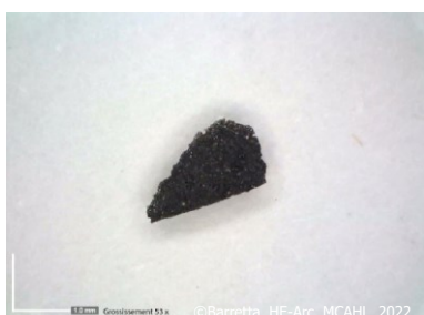
Echantillon de peinture moderne à base d'huile siccative, avant et après spot-test d'identification.
