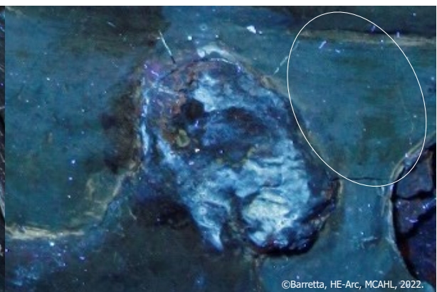
Figure 170 : Observation UV de la fluorescence bleuâtre, registre central, face C. Longueur d'onde UV 365 nm.
