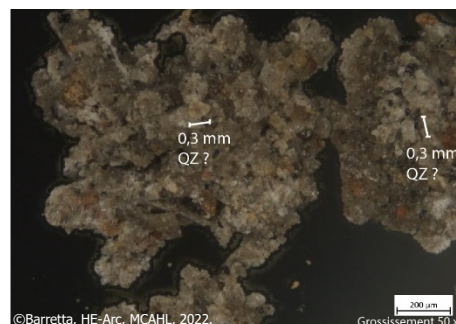
Figure 102 : Vue au microscope optique du mortier de scellement.
